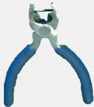
Pinzas para armar con grapa de lámina.
